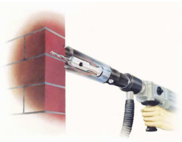
Gerade beim Trockenbohren im Mauerwerk gelangen Bruchstücke durch den Sog an das Bohrkronenende und verstopfen die Saugkanäle.
